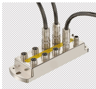
Switch gigabitowy, niezarządzalny eCon 2080, porty iX Industrial Advanced GbE
