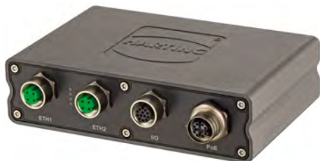
MICA – kompaktowy komputer przemysłowy
